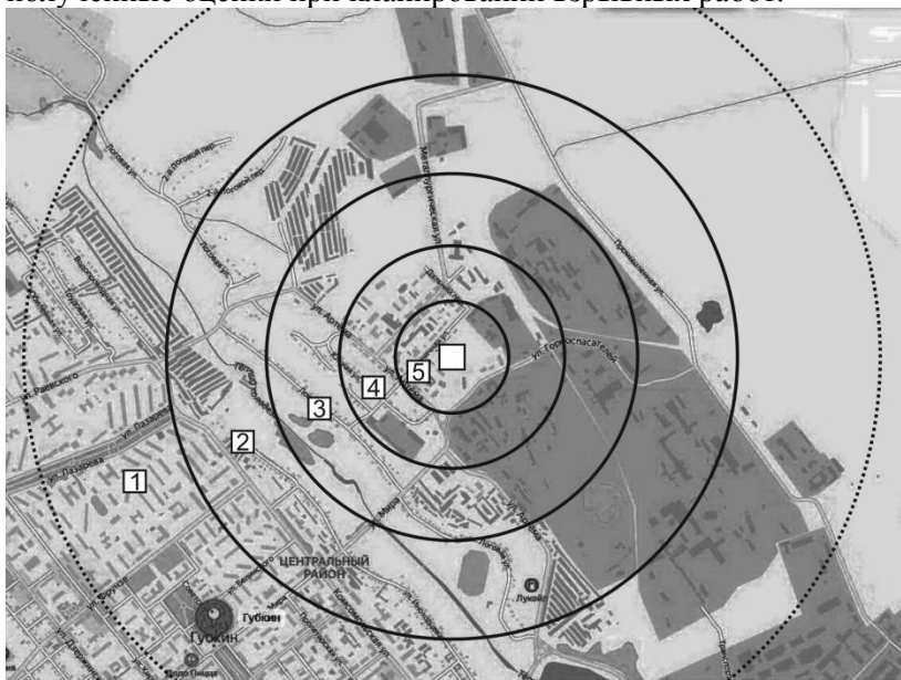
Рисунок 2 - Изосейсты массового взрыва 23.10.2021 в шахте им.Губкина. Суммарная масса ВВ в камере 27,4 т; камера расположена на глубине 283 м от дневной поверхности; цифры в квадратах соответствуют величине балльности в зоне, ограниченной окружностью
