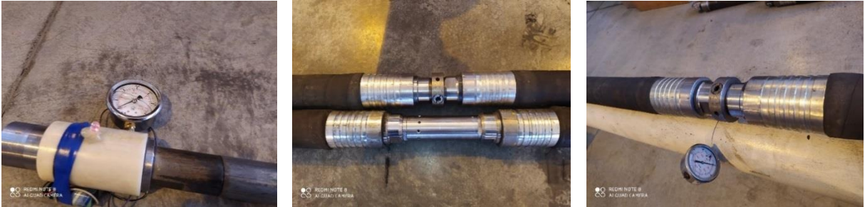
Рисунок 5 - Исследование устройства поинтервального гидроразрыва с различными видами клапанов
