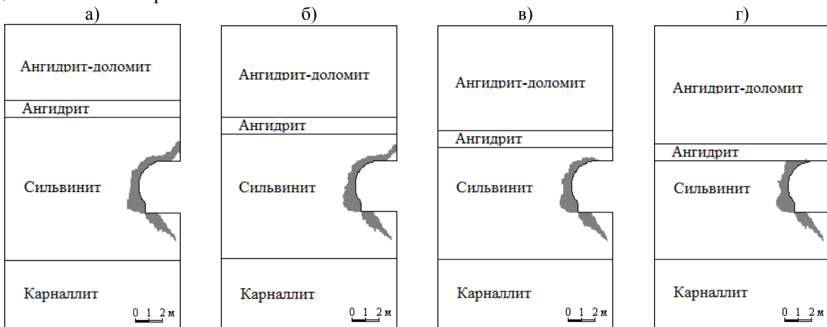
Рисунок 10 - Формирование зон запредельного деформирования в зависимости от мощности соляных пород в кровле выработки: а) 3,0 м; б) 2,0 м; в) 1,0 м; г) 0 м; – области запредельного деформирования пород
