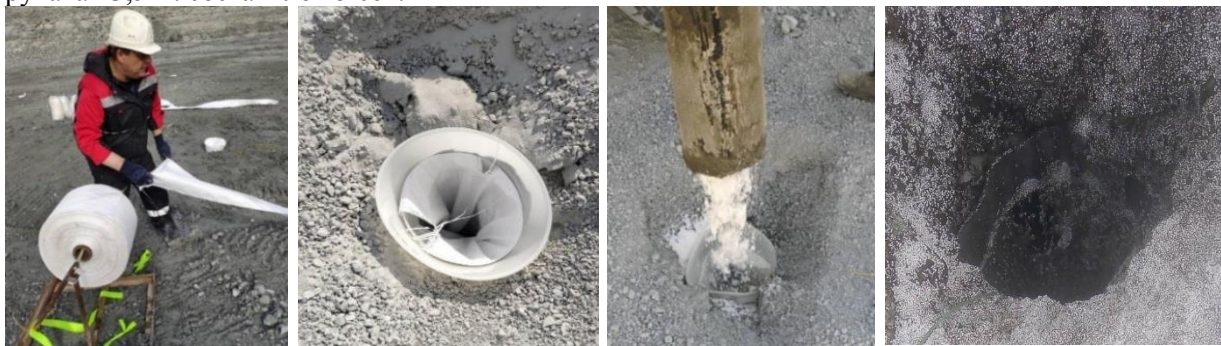
Рисунок 11 – Формирование заряда с радиальным зазором в сухой скважине
